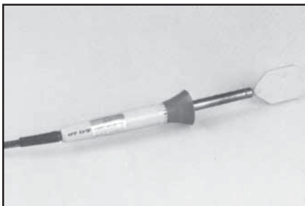
Przyrząd do łączenia wraz z lustrem
